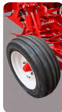
Bagmonteret dybdehjul 250/65x14,5-12pr.
