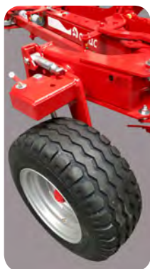
Midtermonteret dyb- de-transporthjul 340/50x16- 18pr.
