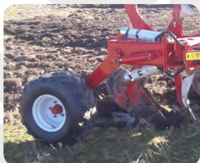
Midtermonteret dybdehjul 250/65x14,5-12pr.
