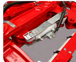
Hydraulisk justering af første fures bredde.
