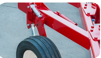
Bakmonterat djuphållningshjul: 6,00 x 9" (standard), 200/60 x 14,5", 250/65 x 14,5", 320/60 x 12", 340/55 x 16" och 380/55 x 17".
