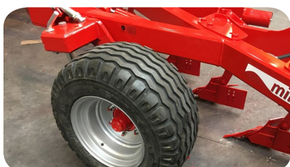
Bakmonterat djup-transport hjul. Enkelt att handha, flytta endast en sprint. Ingen låsning av buffere eller frigöring av stötdämpare behövs.
