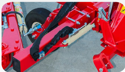
Hydraulisk tiltbreddsjustering av första tilta. (möjligt med extra bred justerings släde på 9 skäriga modellen).
