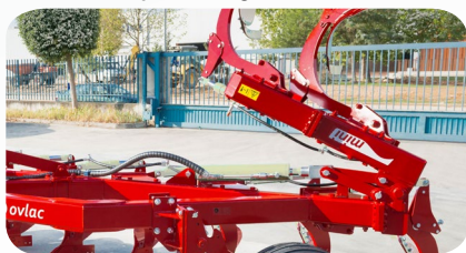
Extra skär, som kan fällas upp hydraulisk för mindre vikt, längd och bredd under transport (endast Mini-BF och HF).
