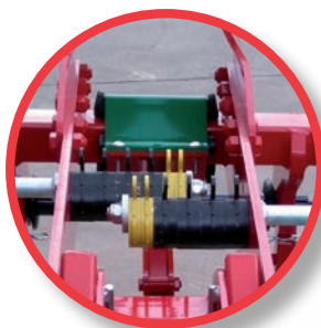
Réglage mécanique à cassettes de réglages.
