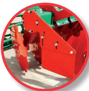
Défecteurs latéraux réglables en inclinaison et en hauteur.
