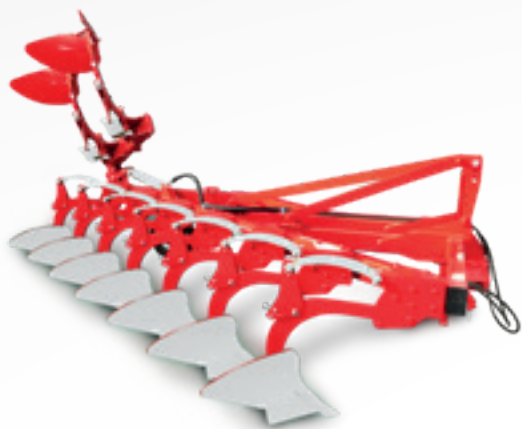
Konventionel trepunktsophængt skræl plov. Fra 5 til 10 furer Mini-BF/HF
