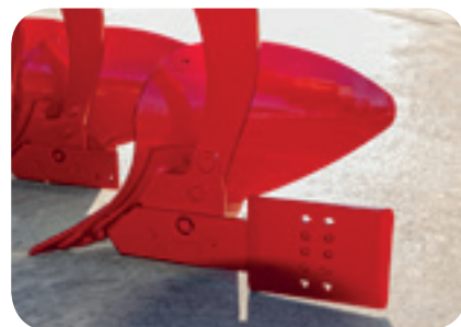
Landside stabiliseringsplade til at forbedre plovens retningsstabilitet
