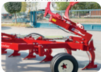
Ekstra furer, der kan foldes hydraulisk for mindre vægt, længde og bredde under transport (kun Mini-BF og HF)
