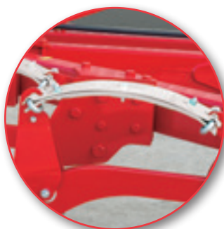
Non-Stop stensikring med bladfjedre Mini-BF
