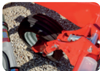
Bagmonteret dybde-transport hjul. Yderst nemt at bruge, flyt blot en splitbolt. Ingen låsning af buffere eller udløsning af støddæmpere påkrævet
