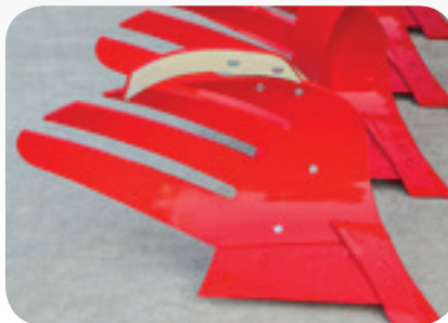
Riste muldplader til klæbrige jordtyper med lav modstand. Monteret med halmskræller til at forbedre dækning af afgrøderester
