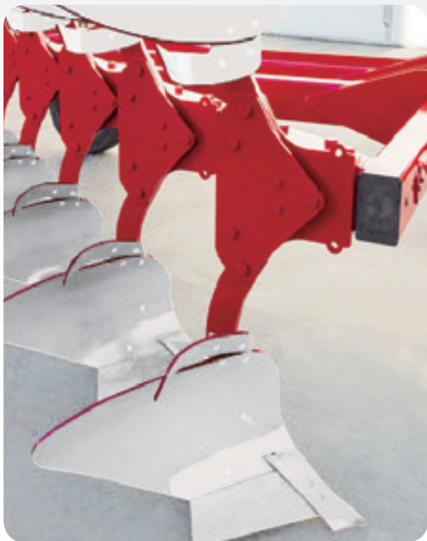
Mini-NF konstruktion med Springbolte stensikring.
