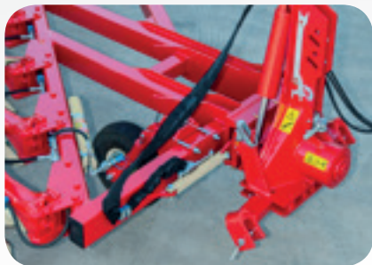
Hydraulisk furebredde regulering af første fure. (mulig med ekstra bred justerings slæde på den 9 furede udgave)
