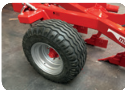
Bagmonteret dybdehjul: 6,00 x 9" (standard), 200/60 x 14,5", 250/65 x 14,5", 320/60 x 12", 340/55 x 16" og 380/55 x 17"
