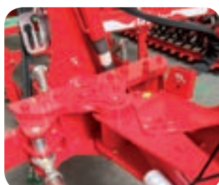
800 mm første furebredde indstilling i stedet for standard 600 mm. Også tilgængelig med hydraulisk justering.
