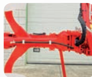
XL åse, 25 kg lettere end standard pr fure og max: 32 hk per fure.
