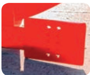
Landsidestabiliseringsplade – højdejusterbar og vendbar.
